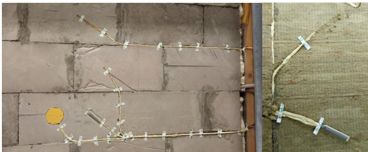
Obrázek 4: Osazení snímačů na vnitřní straně zdicích bloků (vlevo) a snímače na povrchu tepelné izolace souvrství KZS (vpravo)
